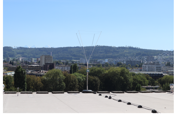
Figure 2 – Système de réception placé sur le toit de la Halle de gymnastique du Gymnase des Alpes à Bienne. Un préamplificateur est placé directement sur le mât de l'antenne pour gagner en qualité de signal.
